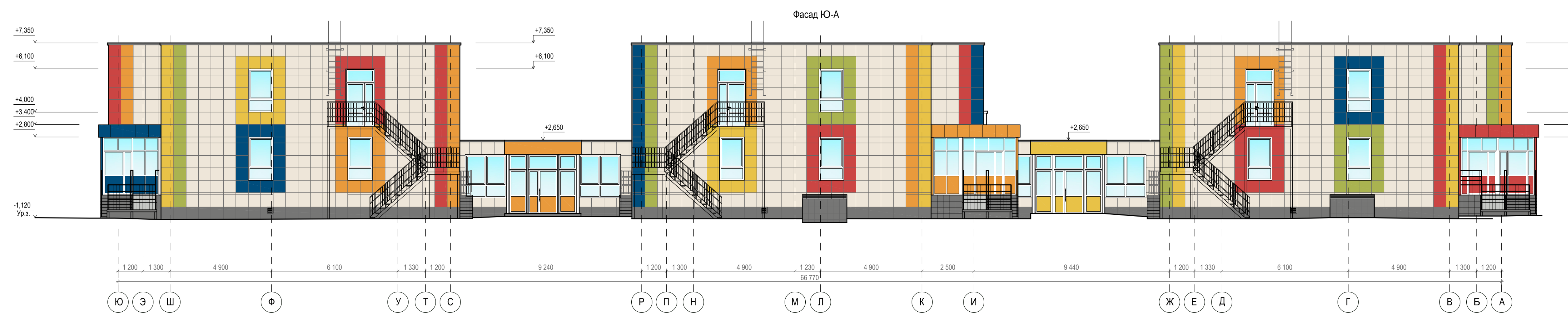
Фасады в осях 1 / Ш-С, 5 / Ю-Ш Схема расположения кронштейнов и горизонтальных профилей
