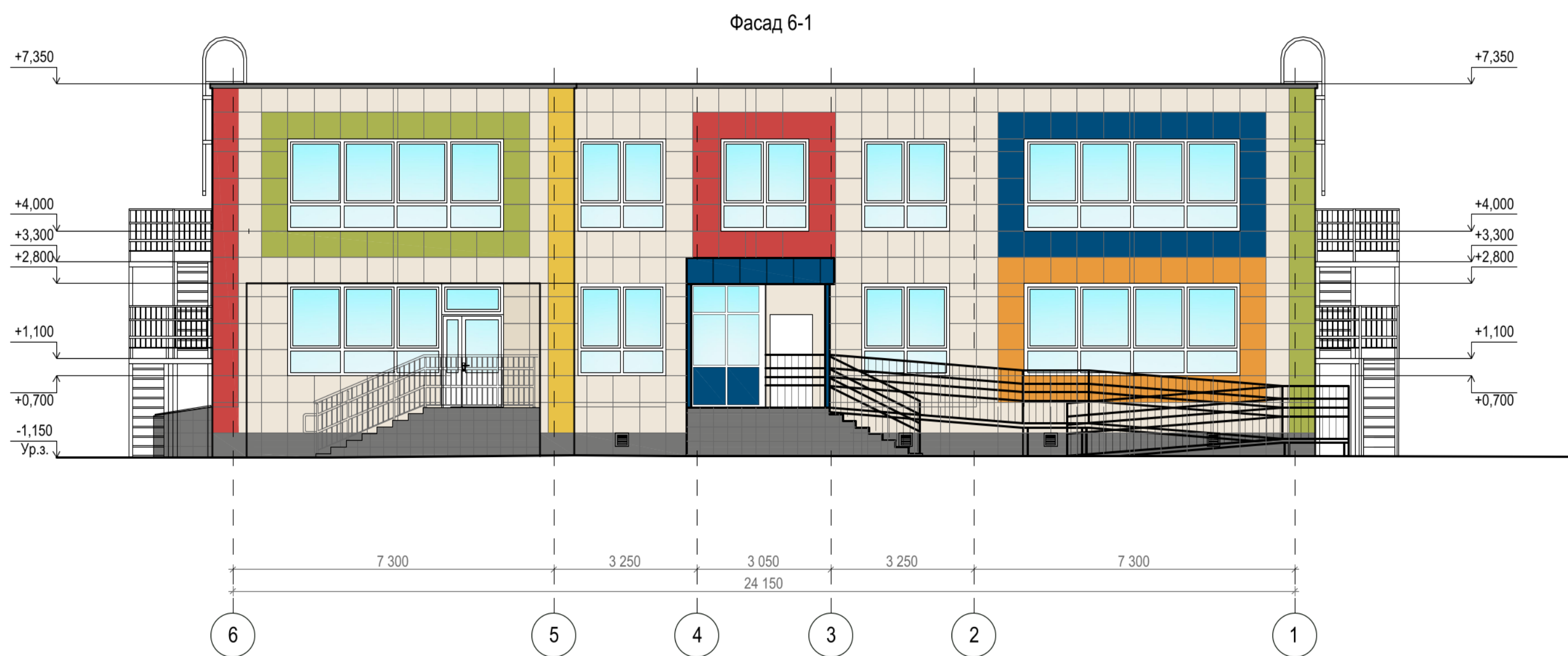
Фасады в осях 6-1 / Ш-Ю Схема расположения крашнейной и горизонтальных профилей
