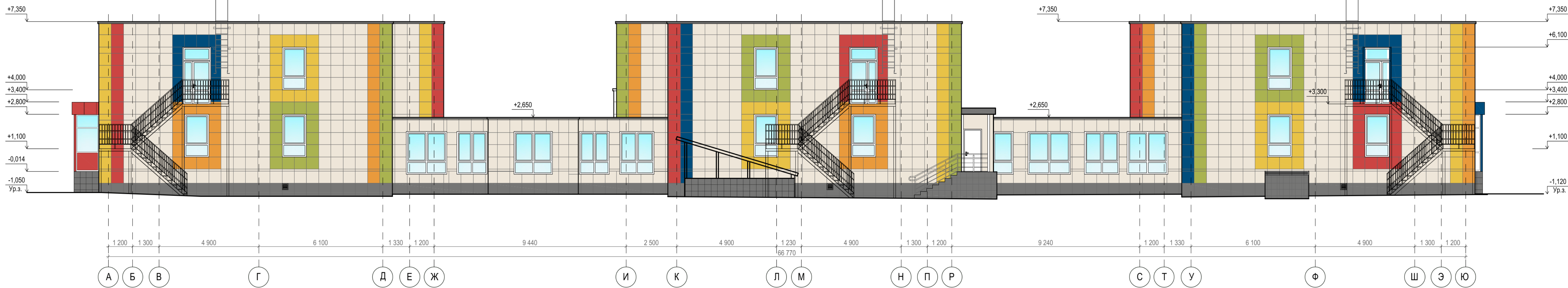
Фасады в осях 12 / А-Д, 8 / Д-Ж Схема расположения кронштейнов и горизонтальных профилей
